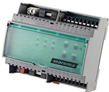
KNX Sonnenschutzaktor zum Schalten von 230 V Sonnenschutzantrieben
