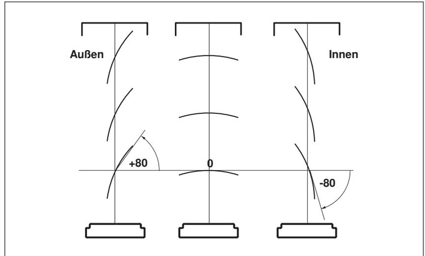
Abb. 11 Lamellenwinkel bei Raffstoren und Jalousien
