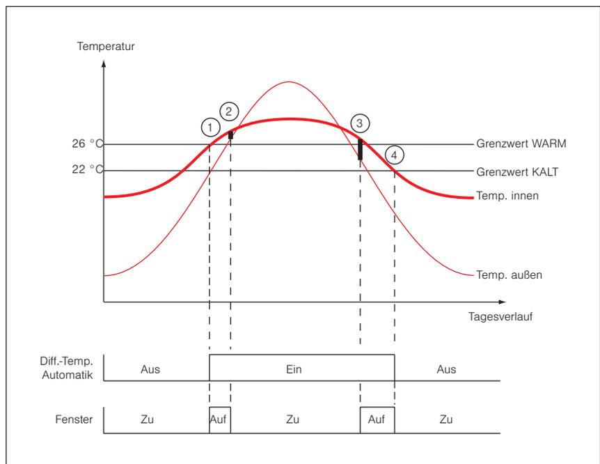
Abb. 15 Differenztemperaturautomatik
