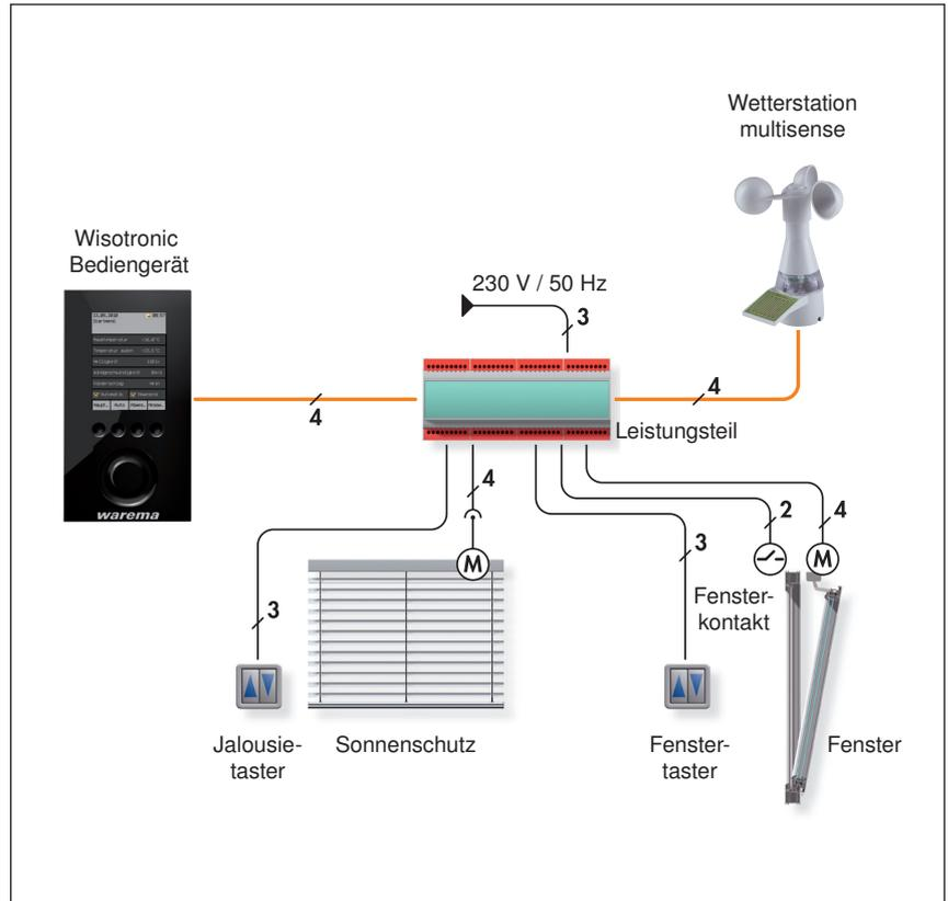
Abb. 3 Überblick über den Aufbau eines Wisotronic Systems
