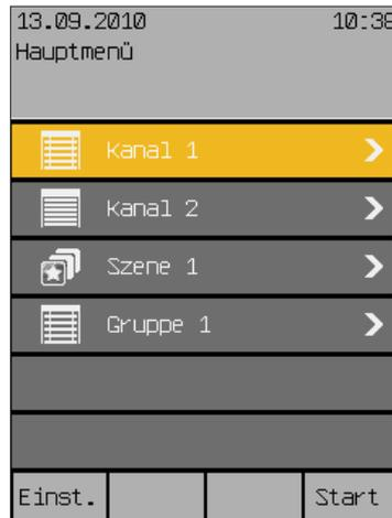
In der Mitte sehen Sie die Tabelle der **Menüzeilen** (bestehend aus den angelegten Kanälen, Gruppen und Szenen), die Sie mit dem Touch wheel anwählen können. Ein Drehschritt im Uhrzeigersinn bewegt die farbig hinterlegte Cursorzeile eine Zeile nach unten, ein Drehschritt gegen den Uhrzeigersinn eine Zeile nach oben.
